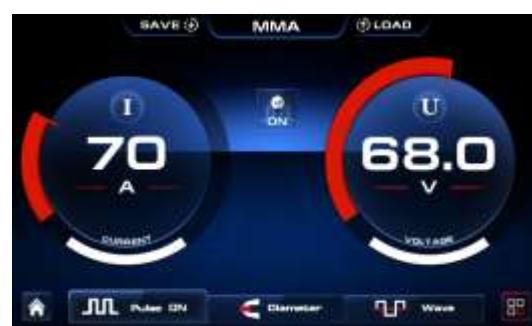
Com o encoder de ajuste (4) pressione-o para selecionar o parâmetro a ser ajustado e gire-o para ajustar os valores de Hot Start, tempo de Hot Start, corrente de base, corrente de pico, percentual de corrente de base (taxa de serviço) e frequência, conforme imagens abaixo.
