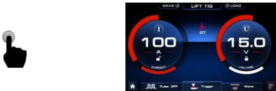
Com o encoder de ajuste (4), ajuste os valores de pré gás, corrente inicial, rampa de subida, corrente principal, rampa de descida, corrente final e pós gás, conforme abaixo.
