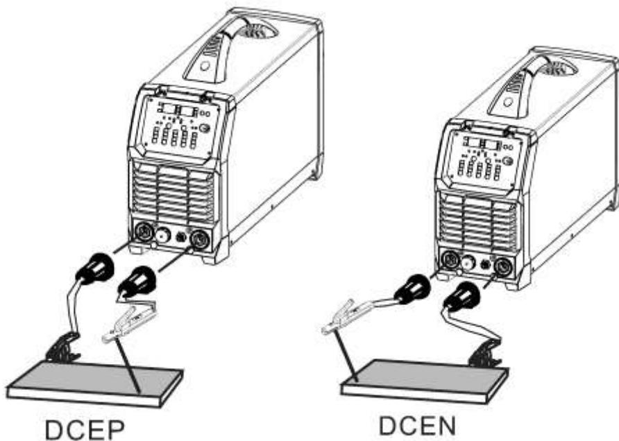
O tipo de conexão, DCEN (negativo) e DCEP (positivo) depende da condição e do tipo de eletrodo e se a soldagem deve ser com maior ou menor penetração. Normalmente é utilizada a conexão DCEP, porém tipos diferentes de eletrodo necessitam de tipos diferentes de conexão, por favor, consulte as especificações técnicas dos fabricantes de eletrodos revestidos.
