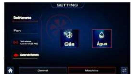
A seleção de refrigeração a água somente é possível se a unidade de refrigeração SRB 180 SMART estiver conectada na fonte de soldagem, conforme abaixo.
