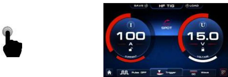
Com o encoder de ajuste (4), pressione para selecionar os parâmetros e gire-o para alterar os valores de pré gás, corrente inicial, rampa de subida, corrente de solda, rampa de descida, corrente final e pós gás.
