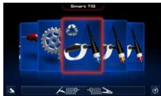
A função smart TIG pode ser considerada como uma função sinérgica, onde o operador deve selecionar o tipo de material, tipo de junta e a espessura do material de solda. Com isso, a fonte de soldagem ajusta os parâmetros conforme as informações inseridas.
