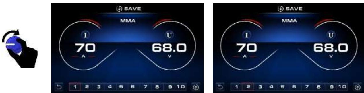
Pressione o botão esquerdo (2) brevemente para voltar a interface de soldagem.
