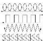
1. Movimento de mergulho do eletrodo em direção à poça de fusão de modo a manter o comprimento de arco constante. Para isto, a velocidade de mergulho deve ser igualada à velocidade de fusão do eletrodo, a qual depende da corrente de soldagem
