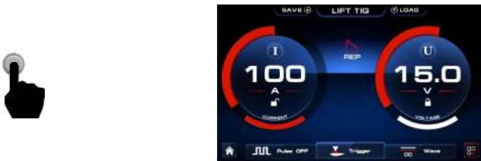
Com o encoder de ajuste (4), pressione para selecionar os parâmetros e gire-o para alterar os valores de pré gás, corrente inicial, rampa de subida, corrente de pico, corrente de base, rampa de descida, corrente final e pós gás, conforme abaixo.
