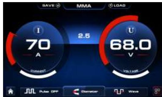
**Hot Start:** Fornece energia extra quando a solda começa para neutralizar a alta resistência do eletrodo e da peça de trabalho à medida que o arco é iniciado. faixa de ajuste (0-100%).
