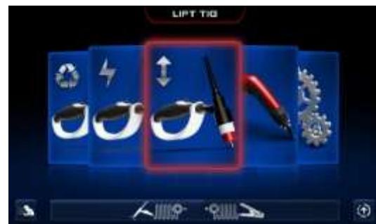
No processo TIG LIFT ARC, quando o eletrodo de Tungstênio toca a peça de trabalho, com o gatilho da tocha pressionado, é gerada uma corrente de curto-círcuito de apenas 10 A. Eleve a tocha, afastando o eletrodo da peça e então o arco de solda com a corrente ajustada se estabelecerá, conforme imagem abaixo.
