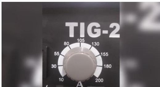
(FIG.1) Seletor de amperagem de 10 a 200 amperes em MMA e TIG com visor digital.
